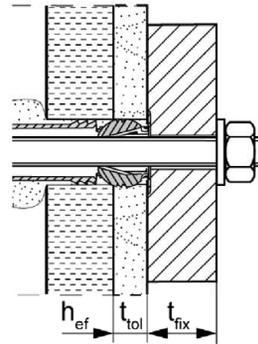
**Größe der Injektions-Ankerhülse:** FIS H 12x85 K    FIS H 16x130 K    FIS H 20x130 K
